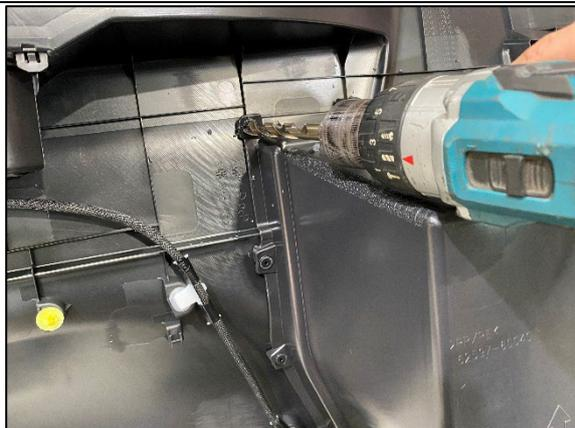
**STEP 1.29** (THIS STEP ONLY APPLIES TO GXL MODELS) USING A 12MM DRILL, GENTLY DRILL OUT THE 9 X PLASTIC LUGS ON THE STORAGE COMPARTMENT AS SHOWN.
