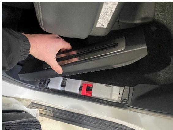
**STEP 1.2** REMOVE PLASTIC TRIM LEVERING UP FROM BODY CLIPS AS SHOWN.
