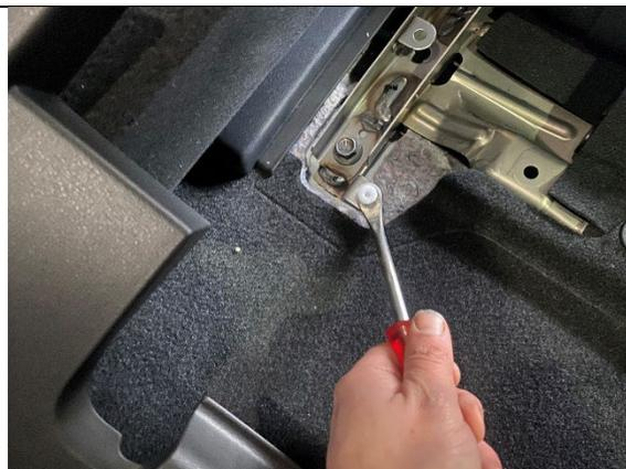
**STEP 1.32** USE A TRIM CLIP REMOVER TO POP OUT OF THE VEHICLE AS SHOWN.
