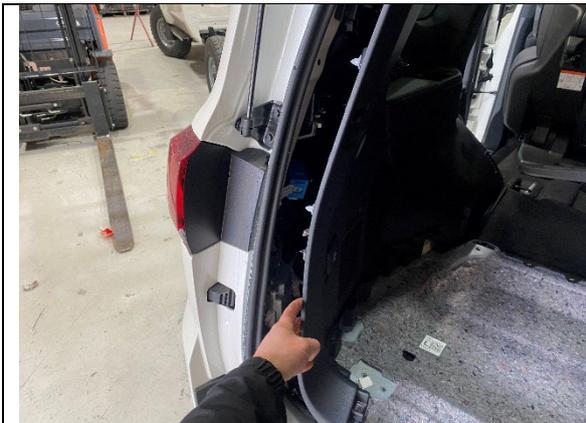
**STEP 1.19** START PULLING BACK THE TRIM CLIPS ALONG THE BACK SECTION TOP TO BOTTOM AS SHOWN. (CHECK FOR TRIM CLIPS)
