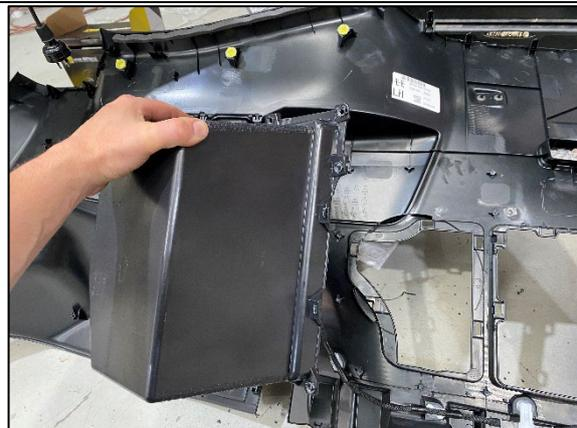
**STEP 1.30** PULL FIRMLY ON 2 X RETAINERS ON RHS AND PULL REAR POCKET OFF TO COMPLETELY REMOVE AS SHOWN.
