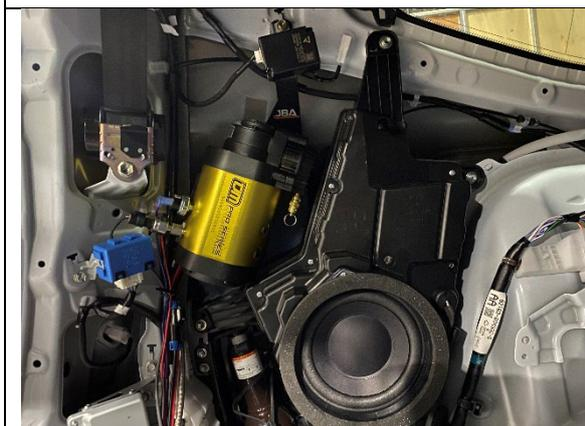
**STEP 3.3** ALIGN THE SUBWOOFER BACK INTO POSITION AND REINSTALL ORIGINAL 4 X TOYOTA M6 SCREWS.
